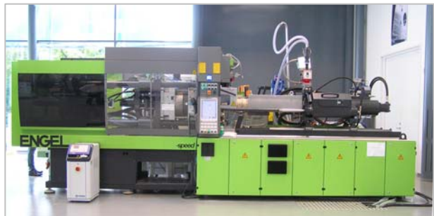
Fig 175. Här ser vi bilden på en modern formspruta av fabrikat Engel. Denna maskin har en hydraulisk knäledslåsning. Det finns även "helelektriska" maskiner som är betydligt tystare än de hydrauliska.
