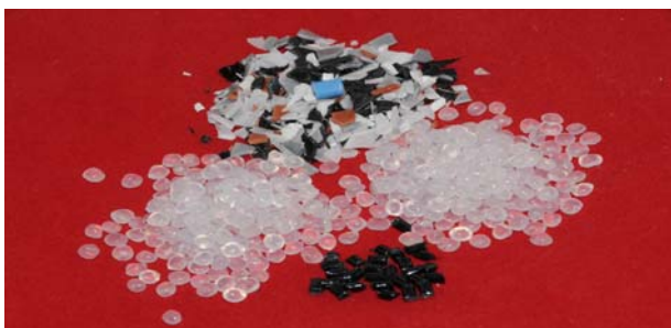
Fig 127. De flesta formsprutare mal om ingöt, ofyllda detaljer etc. Man brukar rekommendera upp till 30 % inblandning av ommalt material i nyvara eftersom detta endast påverkar de mekaniska egenskaperna marginellt. Har man flera olika färger av samma material brukar man tillsätta 1 – 2 % masterbatch och infärga materialet svart.
