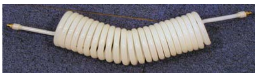
Fig 21. Slangar i PEX klarar både höga temperaturer (120°C) och tryck och används vid varmvattensanslutning av disk- eller tvättmaskiner.
