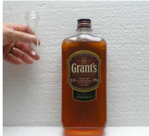
Fig 305. Whiskyflaskan är tillverkad av en preform. Preformen hålls i handen till vänster i bilden.
