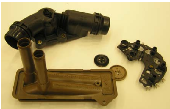
Fig 76. PPS används i krävande varmvatten applikationer som i det svarta termostathuset till BMW eller den bruna kylargaveln. Man tillverkar också högprecisionsdetaljer som skall tåla hög temperatur som diodbryggan till höger eller kemikaliepåverkan som de små impellrarna till bränslepumpar mitt i bilden.
