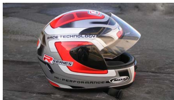
Fig 70. Polykarbonat är otroligt slagseg och lämpar sig därför mycket bra till motorcykelhjälmars eftersom materialet även går bra att lackera. Visiret liksom skyddsglasögon tillverkas också i polykarbonat.
