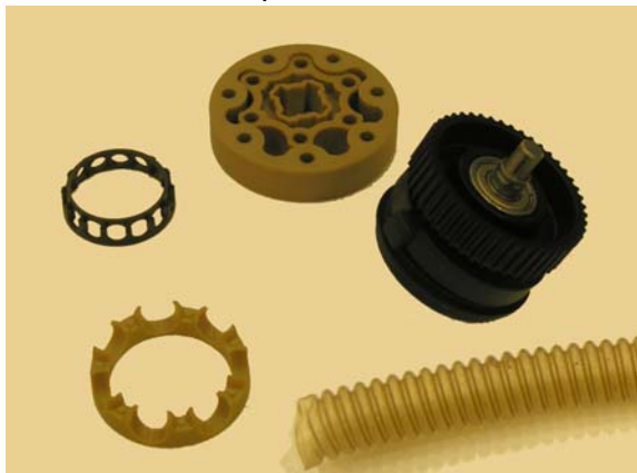
Fig 78. Kullageringar, pumpdetaljer, kugghjul och även slangar där hög precision i kombination med bra mekaniska egenskaper, låg nötning, bra kemikaliebeständighet och extremt hög användningstemperatur krävs tillverkas i PEEK. Foto: Mape Plastics AB
