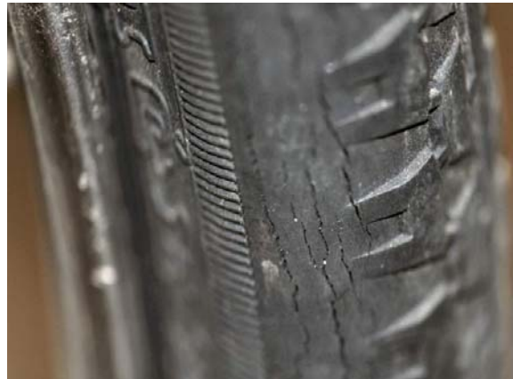
Fig 114. Att gummi (som ju är en syntetisk polymer) självspricker i gummistövlar, cykel- eller bildäck känner väl de flesta till. Detta beror på att syre i luften, i form av ozon, bryter ned materialet. På bilden ser vi ozonsprickor på ett cykeldäck.
