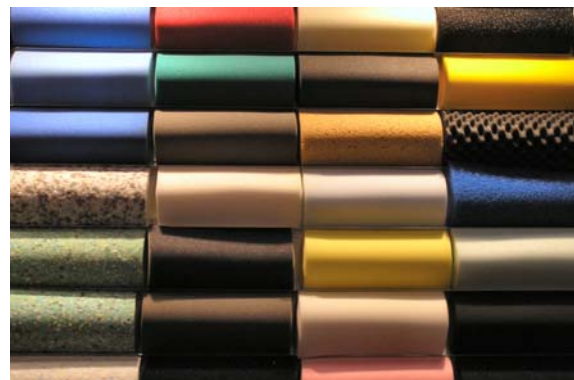
Fig 6. Polyuretan kan förekomma både som härdplast och termoplast. Den kan också vara styv eller mjuk som i den skummade cellplasten på bilden.
