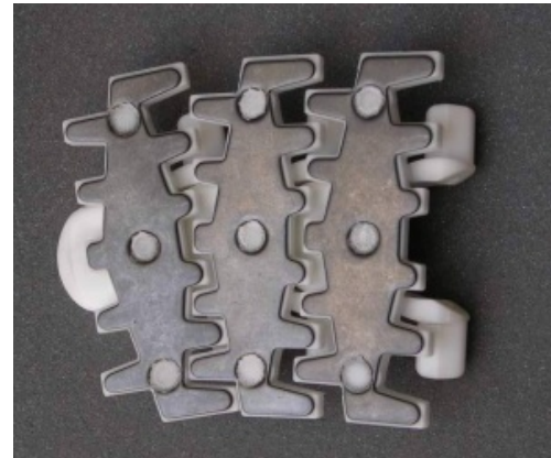
Fig 423. Ovan visas kedjelänkar i acetalplast till ett transportband där man har förbättrat nötningsbeständigheten genom att nita fast en stålplåt på översidan.
