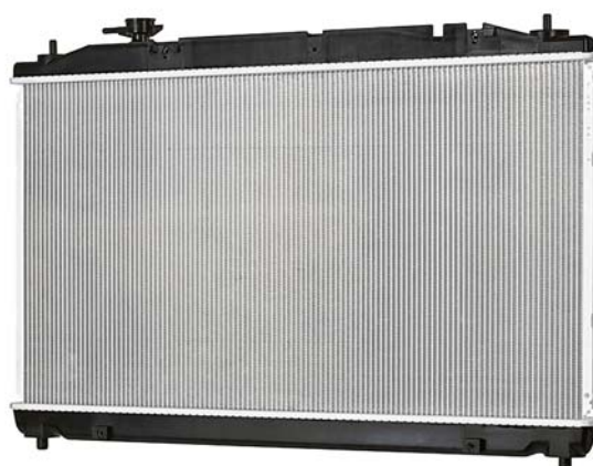
Fig 104. Dessa bilkylargavlar från DENSO Corp är tillverkade i Zytel RS PA610 med 60% förnyelsebar råvara. Den klarar både den höga temperaturen och den kemiskt aggressiva miljön i motorrummet, förutom att materialet också har låg vattenabsorption. Källa: DuPont
