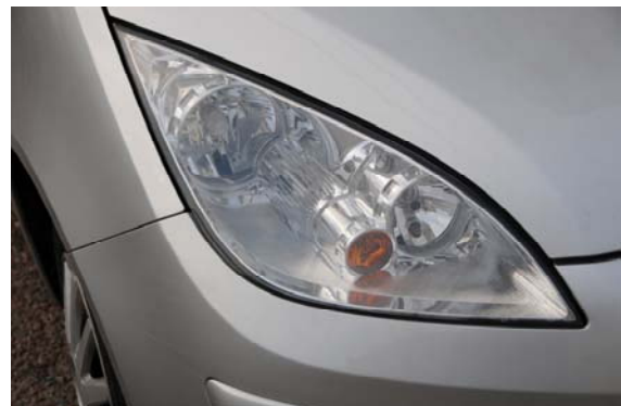
Fig 59. Tack vare att glasfiberarmerad PBT tål hög temperatur, är dimensionsstabil, har hög ytglans och går att metallisera har det blivit ett viktbesparande alternativ till metall i strålkastarinsatser.
