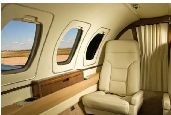
Fig 81. PPSU har extremt bra flamskydd bland plastmaterial och används därför bl.a. till paneler i flygplan.
