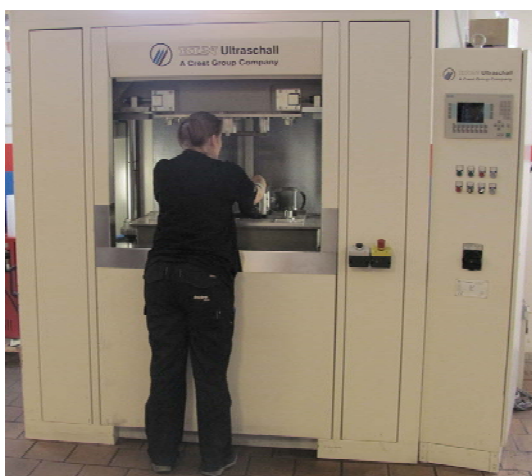
Fig 410. Ovan visas den vibrationssvets som finns hos Stebro Plast AB i Laholm. Man behöver en svets av denna storlek för att svetsa tankhalvorna som visas på bilden till höger. Foto: Stebro Plast AB
