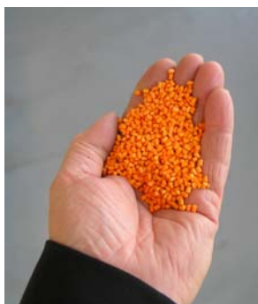
Fig 178 och 179. Plastgranulaten kommer oftast i form av risgrönsstora korn (se bilden till vänster). Granulaten matas in i början på cylindern med hjälp av en doseringsenhet som suger upp materialet från en behållare eller materialtork. Doseringsenheten ersätter tratten, som var så vanlig förr.
