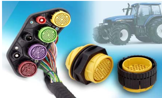
Fig 65. Elkontakter både i fordons- och elindustrin tillverkas ofta i PBT. Både PBT och PET flyter väldigt lätt i formverktygen varför mycket tunnväggigt gods går att fylla utan problem. Foto: DuPont
