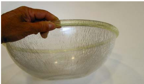
Fig 67. Polykarbonat har dålig kemikaliebeständighet, som framgår av salladsskålen ovan där sprickorna har utlösts av vinäger.
