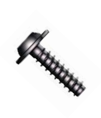
Fig 403. Om man skall ha ett bra skruvförband med självgängande skruv bör plastmaterialet ha en styvhet lägre än 2 800 MPa (d.v.s. samma som för oarmerad POM). För styvare material t.ex. glasfiberarmerade rekommenderas ett gängat hål (med gängtapp) eller gängade insatser. Man bör också välja en skruv som är speciellt utvecklad för plastmaterial.
