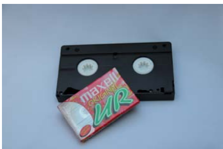
Fig 122. Hjulen i audio- eller videokassetter tillverkas i ledande (antistatbehandlad) acetalplast för att minska risken för avmagnetisering av tapen.
