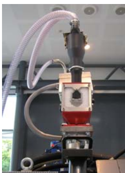
Fig 178 och 179. Plastgranulaten kommer oftast i form av risgrönsstora korn (se bilden till vänster). Granulaten matas in i början på cylindern med hjälp av en doseringsenhet som suger upp materialet från en behållare eller materialtork. Doseringsenheten ersätter tratten, som var så vanlig förr.
