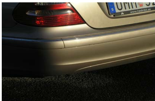
Fig 177. Formsprutad spoiler i PP med EPDM. Den har s.k. klass A-yta och är lackad med samma färg som karosseridelarna i plåt.
