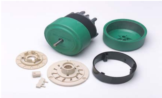
Fig 64. Både PBT och PET har bra elektriska isoleringsegenskaper. Kapsling och rotor till denna lilla elmotor är tillverkade i glasfiberarmerad PET. Foto: DuPont
