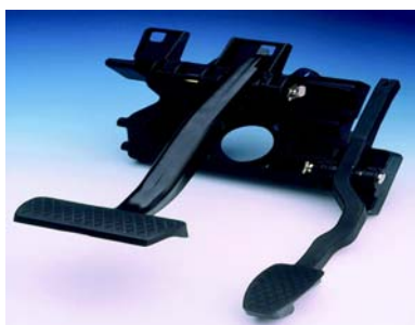
Fig 47. I pedalställ till bilar har slagseg glasfiberarmerad polyamid ersatt metall med stor viktbesparing som resultat. Foto: DuPont
