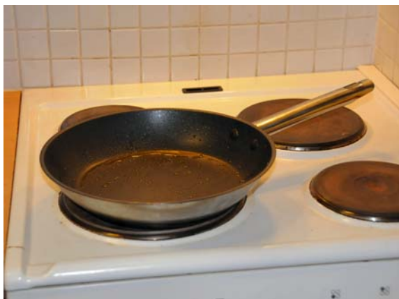
Fig 71. Teflon®-pannor är ett utmärkt exempel på en produkt där man drar nytta av PTFE:s överlägsna temperatur- och kemikalieresistens i kombination med låg friktion ("non-stick").
