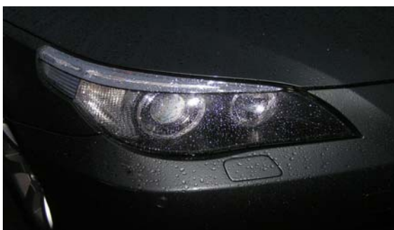
Fig 69. Glaset till bilstrålkastare tillverkas i polykarbonat och beläggs med ett tunt skikt av siloxan för att förbättra reptåligheten, UV-skyddet och skydda mot lösningemedel.
