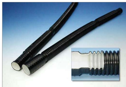
Fig 307. Bilden visar en korrugerad slang som är tillverkad med ett multilagerhuvud i två olika material. Det vita materialet har bra barriäregenskaper och den svarta manteln är tillverkad i ett nötningsbeständigt material. Foto: DuPont
