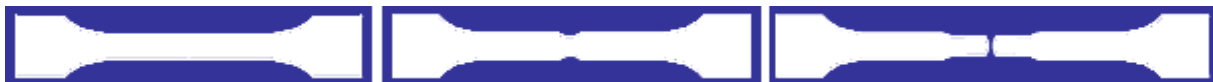
Fig 133. Så länge man befinner sig i område A) eller B) i kurvan i fig. 131 återtar en provstav sin ursprungliga form efter avlastning. När man kommer över den s.k. töjgränsen vid C) uppstår en midja som förlängs tills brottet uppstår vid D) (provstaven till höger).
