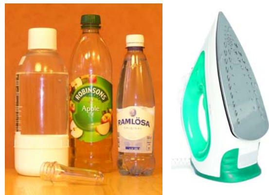
Fig 57. Polyester är ett material som kan förekomma i många olika varianter. På bilderna ovan ser vi flaskor i amorf PET och ett strykjärn i glasfiberarmerad delkristallin PET.
