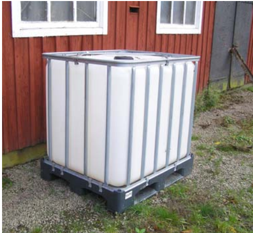
Fig 304. Tanken ovan rymmer c:a 1 m 3 och är exempel på formblåsning med parison.
