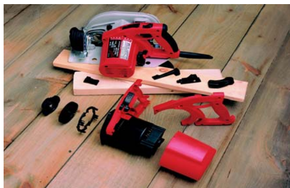
Fig 46. Elektriska handverktyg har nästan alltid kåpor i slagseghetsmodifierad polyamid eftersom materialet klarar hårdhänt behandling och har bra elektriska isoleringsegenskaper. Foto: DuPont
