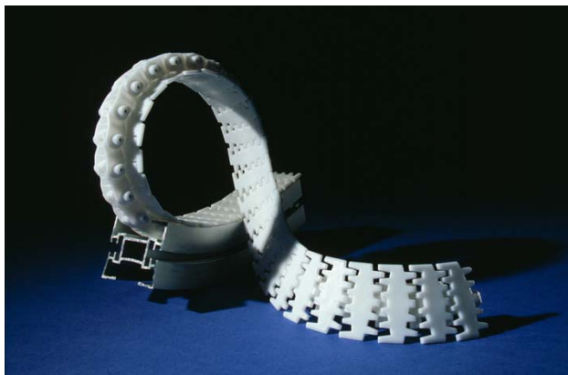
Fig 117. Länkar till transportkedjor tillverkas nästan uteslutande i acetalplast. För att minska friktionen, vilken i sin tur reducerar effektuttaget av drivmotorerna, och slitaget väljer man silikonolja eller fluorplast som tillsatsmedel. Foto: Flexlink AB
