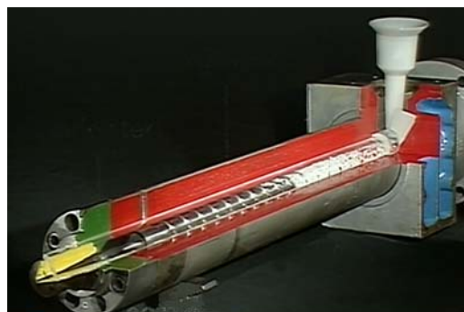
Fig 180. Ovan visas en sprängskiss av en cylinder. Tratten sitter längst bak och munstycket längst fram. Inuti cylindern ligger skruven och utanpå sitter värmebanden som tillsammans med friktionsvärme från skruven smälter plastgranulaten.
