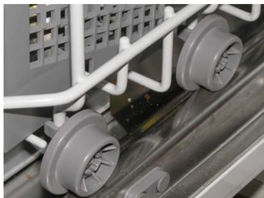
Fig 50. Hjulen på korgarna i diskmaskiner tillverkas i acetal copolymer eftersom varmvattenbeständigheten är bättre än för acetal homopolymer.
