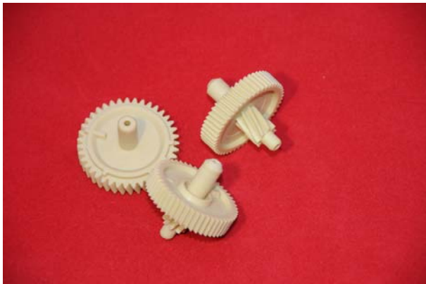
Fig 112. Kevlar®-fibrer är oerhört starka och ger bra armeringseffekt i både polyamid och acetalplast. Kugghjulen till vänster är tillverkade i Kevlar®-armerad Delrin® acetalplast. Kevlar®-fiberns naturfärg är svagt gul vilket man kan se på bilden. Fördelen med att välja den betydligt dyrare Kevlar®-fibern istället för glasfiber är att man både sparar vikt och får mycket bra nötningssegenskaper.
