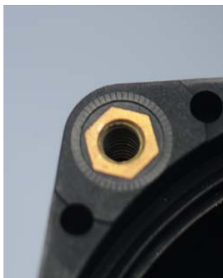
Fig 404 och 405. Ovan till vänster ser vi en gängad mässingbussning i väggen på en detalj tillverkad i glasfiberarmerad polyamid 66. Bussningen kan antingen övergjutas eller pressas in i plastväggen.
