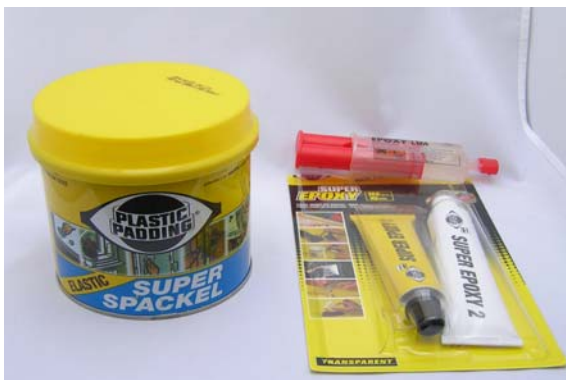
Fig 5. Plastic Padding eller s.k. tvåkomponentslim förekommer i många hem. Här blandas två komponenter med varandra, varvid en kemisk förnätningsreaktion startar och gör materialet hårt (det härdar). En av komponenterna kallas därför härdare. Reaktionen sker i detta fall vid atmosfärstryck och är en s.k. lågtrycksreaktion.
