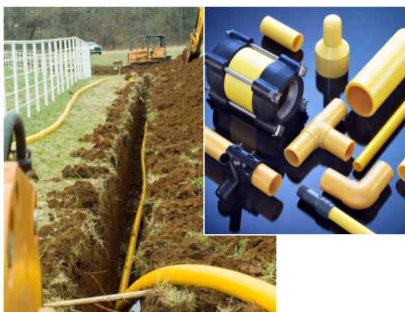
Fig 103. Dessa gasledningar och kopplingar för gasrör tillverkas i Rilsan PA11 för att användas i tryckrör för naturgas med dimension upp till 100 mms diameter och arbetstryck upp till 14 bar. Detta material innehåller 100 % förnyelsebar råvara. Källa: Arkema
