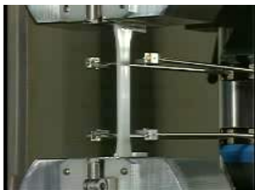
Fig 129. Bilden visar en provstav i en dragprovare. Alla plastråvarutillverkare mäter de mekaniska egenskaperna på provstavar som tillverkas enligt olika ISO-standarder, vilket gör att man kan jämföra data mellan olika tillverkare. Foto: DuPont
