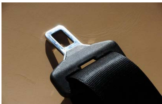
Fig 176. Formsprutat bälteslås till säkerhetsbälte i bilar, där man har översprutat en stansad och förkromad stålplåt med en konstruktionsplast.
