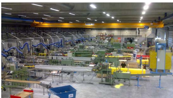
Fig 308. Bilden visar extruderingshallen hos Talent Plastics Göteborg AB (f.d. Profilspecialisten) i Källered, en av Sveriges största och ledande extruderare av profiler. Bredden och längden för en typisk extruderingslinje är c:a 4 x 25 meter.
