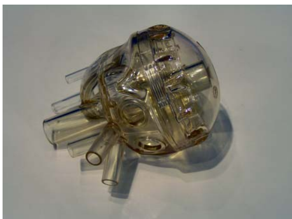
Fig 80. PSU kan fås livsmedelsgodkänt och används bl.a. i detaljer till mjölkningsmaskiner. En fördel här är att produkterna är transparenta och att man kan ångsterilisera dem vid rengöring.
