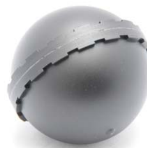
Fig 413. Ovan visas en kulformad flottör tillverkad i glasfiberarmerad polyamid som har svetsats med hjälp av rotationssvetsning.
