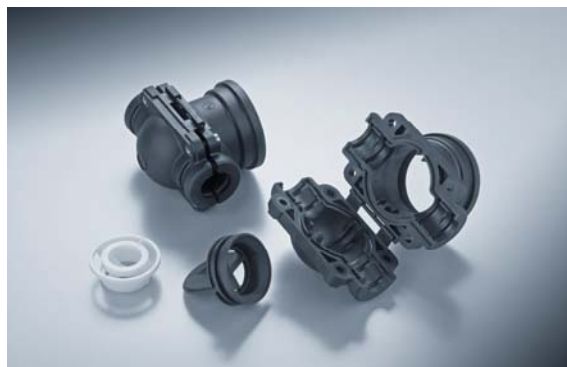
Fig 77. PPS är godkänt i drickvattensapplikationer, vilket var ett krav i vattenmätaren "AGAWA" ovan. Materialet i vattenmätaren, som förutom extremt bra kemikalie- och temperaturrestans också har hög styvhet och krypresistens egenskaper heter Fortron och tillverkas av Ticona.
